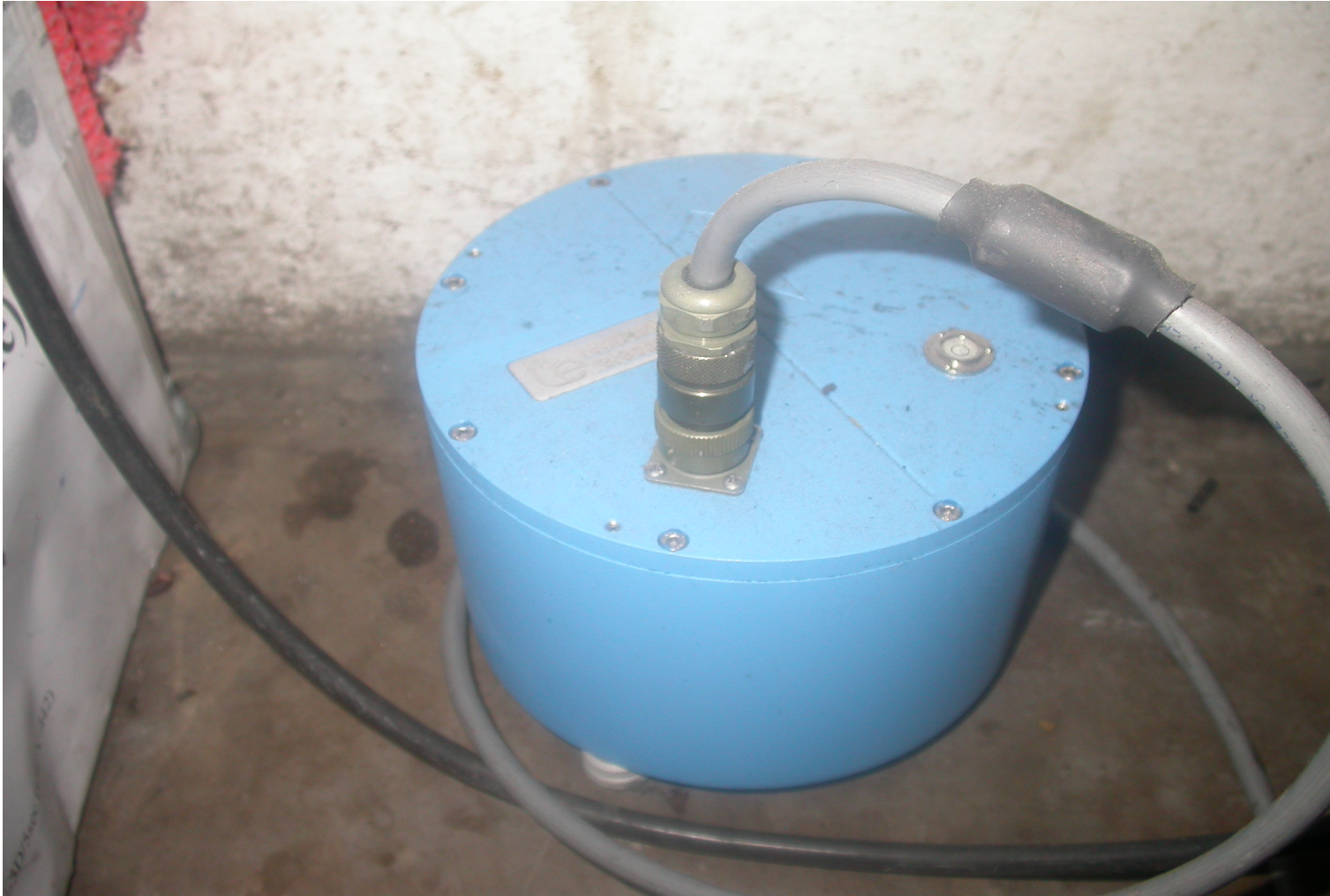
Un nouveau réseau de séismomètres digitaux, trois composantes, est en cours d'installation autour des volcans.
